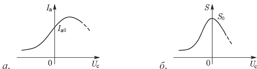
ნახ. 1.20. ა) ანოდური დენისა და ბ) ბადური სიმრუდის ბადურ ძაბვაზე დამოკიდებულების გრაფიკები
