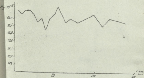
ნახ. 1.2. ბეტონის ფართობითი დეფორმაციების ცვლილება თაღვან /ა/ და კონსოლურ /ბ/ მიმართულებებში გამყარების საფეხის პერიოდში.
