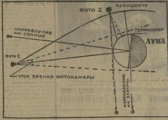
Схема облета и фотографирования Луны автоматической станцией «Зонд-6». На схеме указано: 1 — начало первого сеанса фотографирования; 2 — начало второго сеанса фотографирования.
