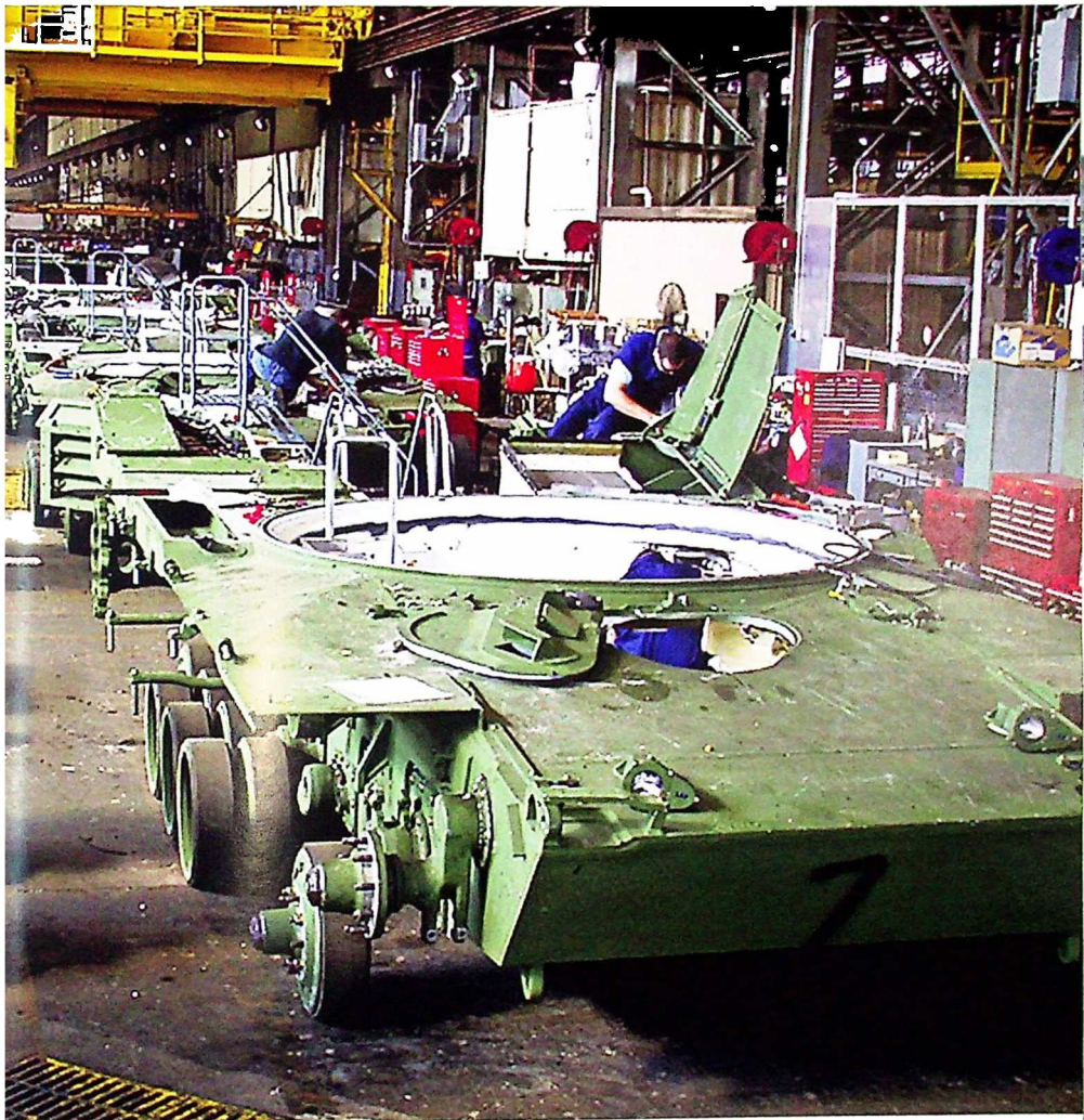
„M1 აბრამსი“ ქარხნის კონვეიერზე. ამ 60-ტონიანი, 105 მმ ძირითადი ქვემეხით აღჭურვილი ტანკების წარმოება 1980 წელს დაიწყო. კორპორაცია „ჯენერალ დაინფიკსის“ არქივიდან
