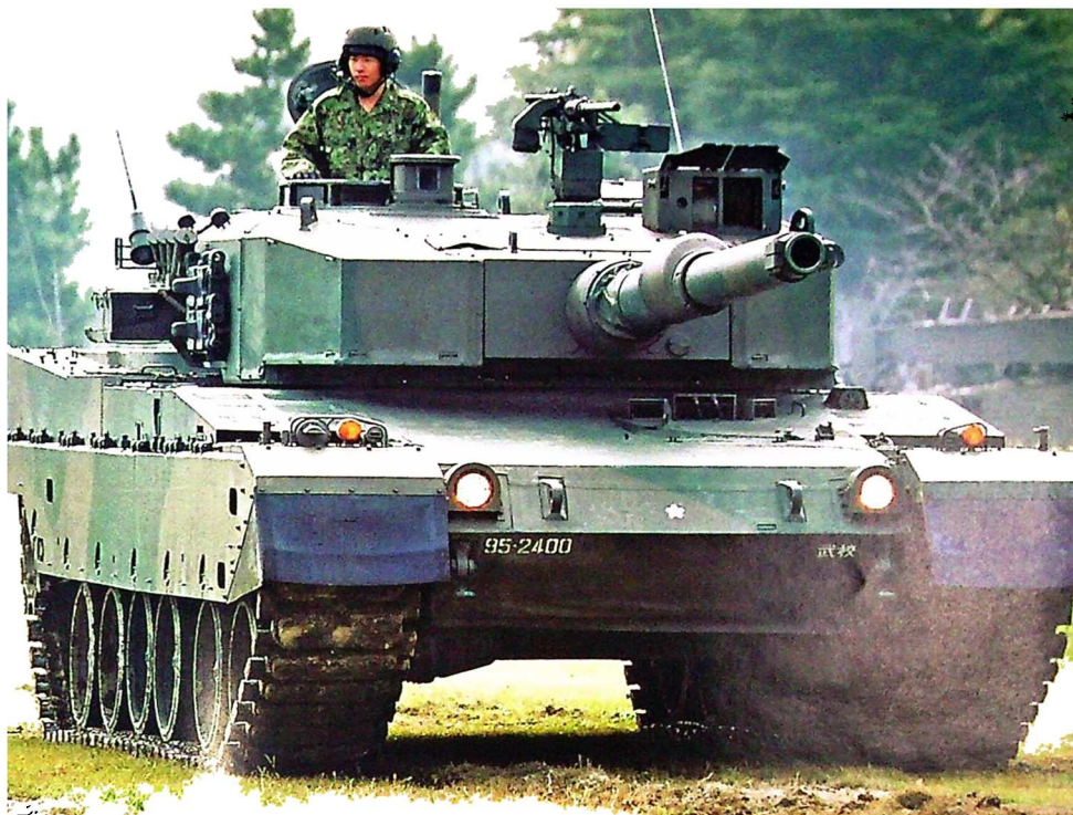
1991 წელს აპონიის არმიამი გამოიწნდა სამკაციანი ძირითადი საბრძოლო ტანკი „ტაიპ 90“, 120 მმ ძირითადი ქვემეხით. მან „ტაიპ 74“ შეცვალა. მიცუო იაგუნი
