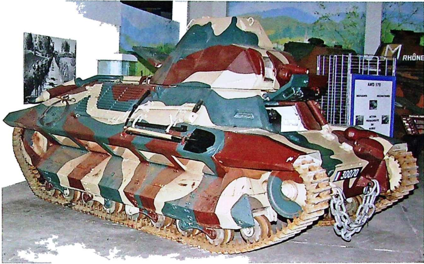
1939 წელს საფრანგეთის არმიამ შეიძინა ორკაციაანი მსუბუქი ტანკი FCM 36. ამ 12-ტონიანი ტანკის შეიარაღება შედგებოდა 37 მმ ძირითადი ქვემეხისა და ერთი ტყვიამფრქვევისაგან. კრისტოფერ ვალიერი
