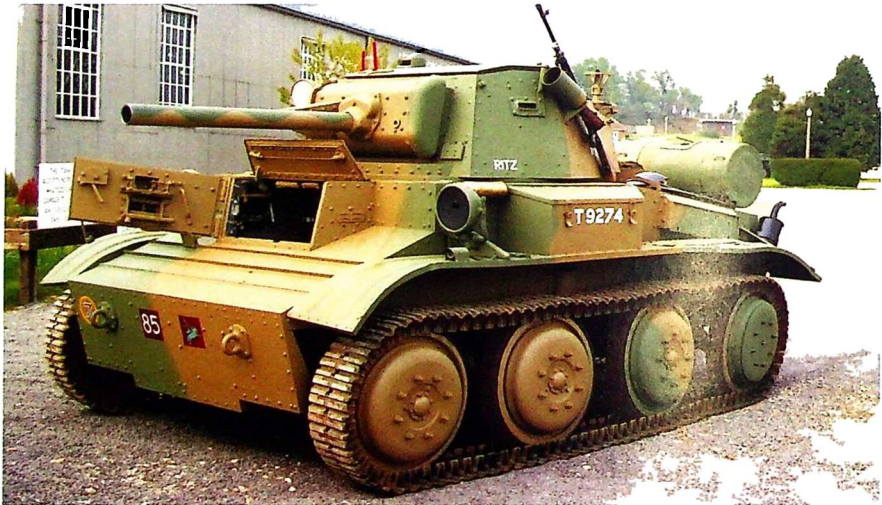
ბრიტანული ტანკის „ტეტრარქ VII“-ის ბორტზე დამაგრებული იყო 40 მმ ძირითადი ქვეშეზი და ერთი ტყვიამფრქვევი. 1944 წლის 6 ივნისს საფრანგეთში გადასხდომისას ეს ტანკები გერმანელთა ზურგში გადაისროლეს. ტანკის მუზეუმი, ბოვინგტონი
