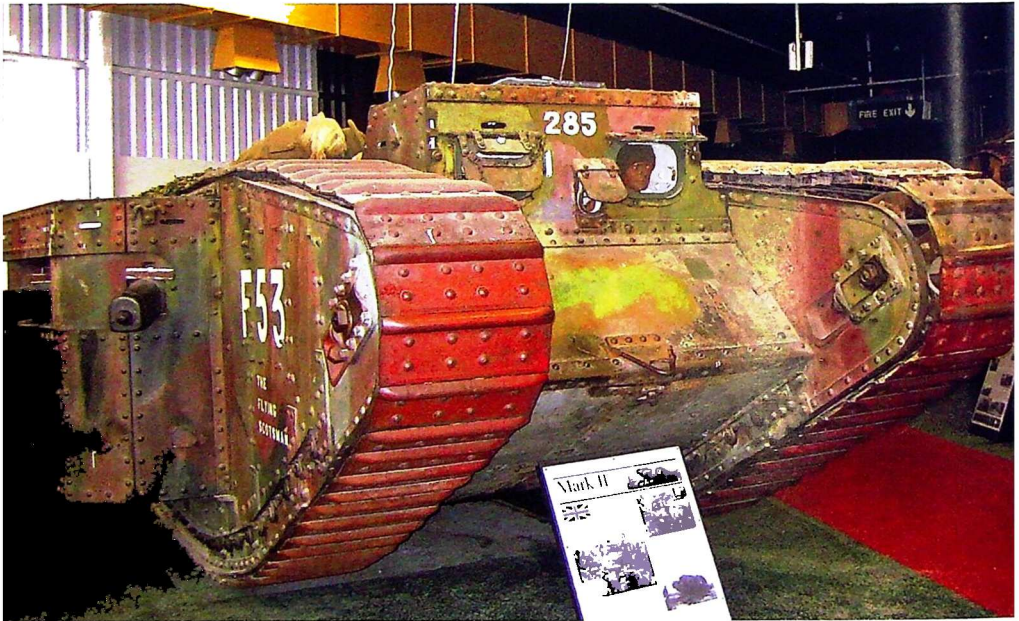
„მარკ-II“ მცირე დიზაინერული დეტალებით განსხვავდებოდა „მარკ I“-საგან. ეს შემონახული მოდელი, რომელსაც მხოლოდ ტყვიამფრქვევები აქვს, „მდედრობითი“ ტიპის ტანკადაა კლასიფიცირებული. ტანკის მუზეუმი, ბოვინგტონი
