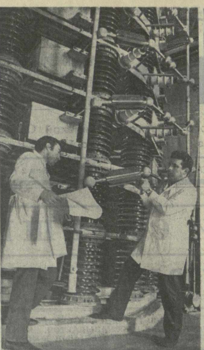
▲ В БАТУМСКОЙ ЛАБОРАТОРИИ ВЫСОКИХ НАПРЯЖЕНИЙ Тбилисского филиала Всесоюзного научно-исследовательского института метрологии имени Менделеева разрабатывается методика аттестации деталей высокой напряженности пластического и парамагнитного тона, позволяющих повысить точность измерений высокой напряженности. На снимке: ведущий инженер Д. Хачия (слева) и старший инженер Р. Хохурианидзе готовят очередную эксперимент. Фото О. Лувачева.
