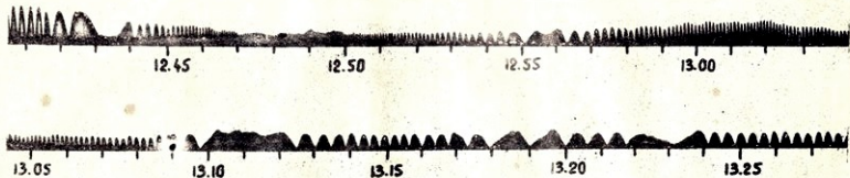
Рис.10. Образец записи поляризационных бле- ний радиосигнала, отраженного от области F (Табакмела, 25 марта 1981 г.)
