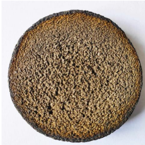
სურ. 2. თვითგავრცელებადი მაღალტემპერატურული სინთეზის მეთოდით მიღებული 30%-იანი ფორიანი ნეიტრალიზატორ-კატალიზატორის ნიმუში
