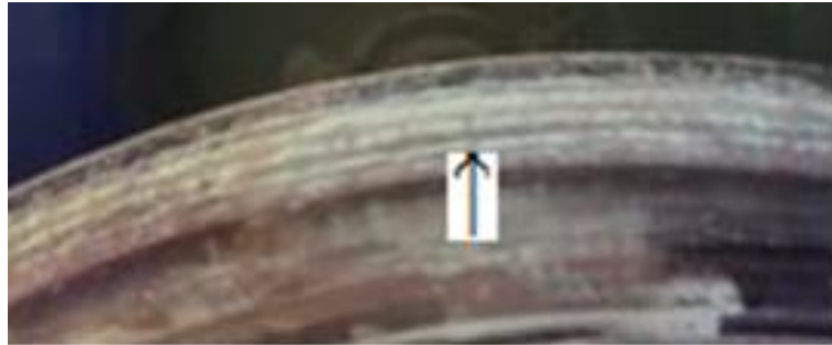
ნახ.6. გოგორათვალის ქიმის ადდგენისას პირველი ლილვაკის დადუღების დაწყების ადგილი გორვის ზედაპირზე (ისრიტ ნაჩვენებია გორვის ზედაპირზე დადუღებული პირველი ლილვაკი)
