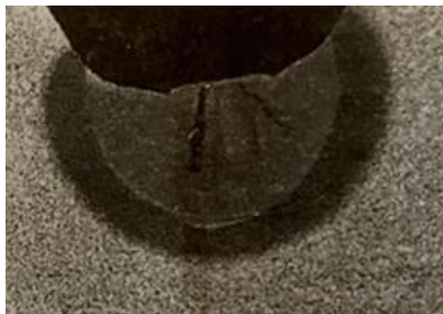
ნახ.3. დადუღებულ ლითონში წარმოქმნილი ცხელი ბზარები დენის ძალის გაზრდისას 330 ა-მდე
