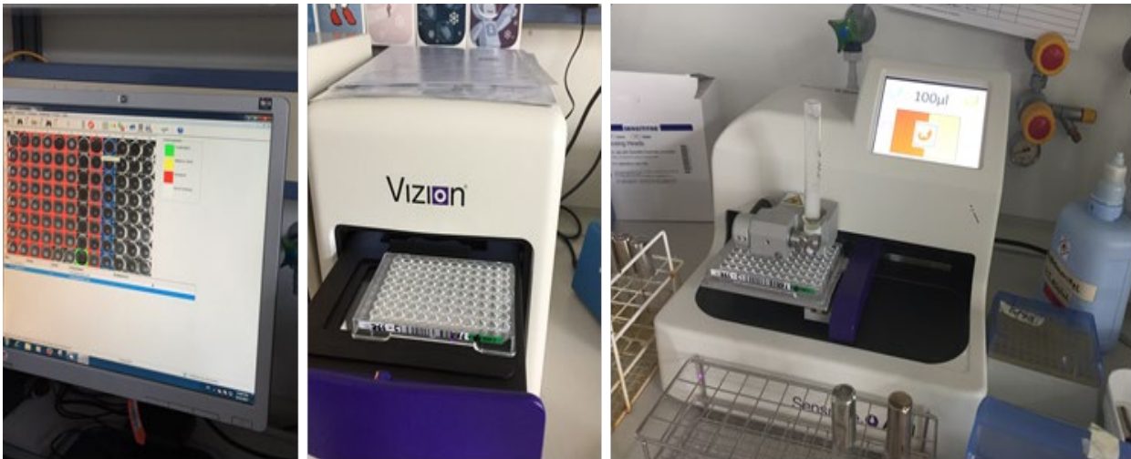
სურათი 3. MIC-ები (mg/L) ინოკულირება და გაანალიზება ნახევრადავტომატური მოწყობილობით SensiTitre system (TREK Diagnostic Systems), ფირფიტების ვიზუალური დეტექცია და MIC-ის შედეგების ექსპორტი SensiVizion პროგრამაში.
