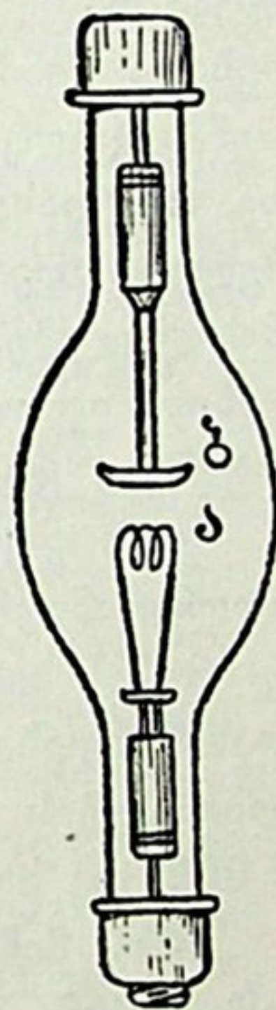
ნახ. 4. კენოტრონის სქემა ა — ვოლფრამის ხვია ბ — ვოლფრამის ფირფიტა
