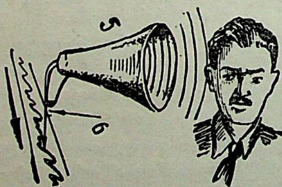
ნახ. 2. ბგერათმანქანის მექანიკური სისტემის პრინციპული სქემა: 1—მიმღები რუპორი მემბრანით, 2—საჭრისი, 3—ამოჭრილი ღრამი, 4—ცელულოიდის ლენტი, 5—აღმღვნი რუპორი, 6—ნემსი
