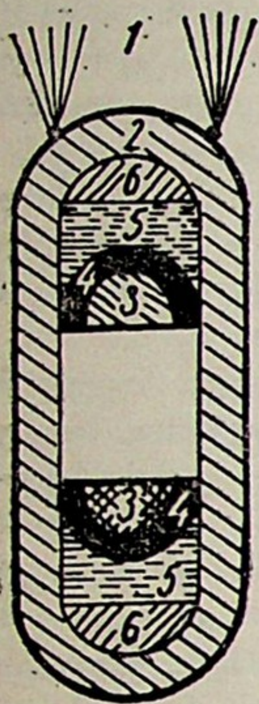
1—პარაშუტი, 2—გარსი, 3—ბირთვული ფეთქებადი ნივთიერება, 4—ამრეკლავი, 5—ტროტილის მუხტი, 6—ამფეთქებელი
