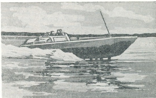
ინჟინერ რ. ალექსეევის კონსტრუქციის წყალქვეშაფრთხიანი კატარის გამოცდა. ვოლგაზე, გორკის მახლობლად, კატარამ განავითარა 130 კილომეტრი სიჩქარე საათში.
