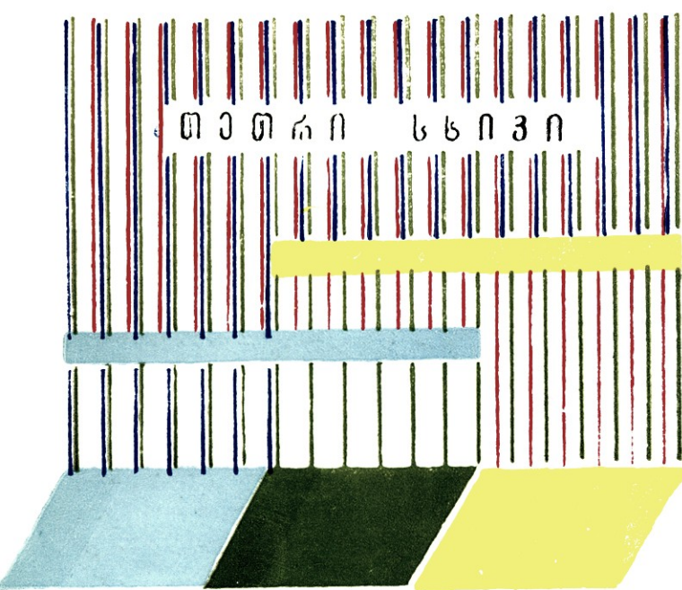
ნახ. 4. მწვანე ფერის მიღება სუბტრაქტულად: ცისფერმა შუქფილტრმა შთანთქმა წითელი სხივები, ყვითელმა — ლურჯი. ორივემ მხოლოდ მწვანე სხივები გაატარა.
