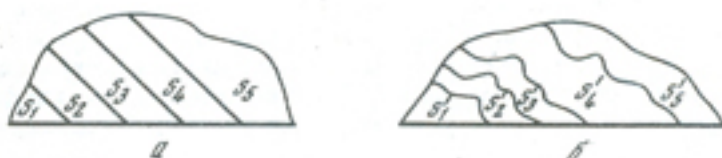
Рис. 35. Рисунок изохрон добегаия для ровного (а) и неровного (б) склонов
