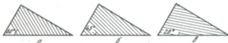
Рис. 34. Изохроны добегаия на прямом склоне треугольной формы а - при v_{\text{скл}} > v_{\text{рус}} ; б - при v_{\text{скл}} = v_{\text{рус}} ; в - при v_{\text{скл}} < v_{\text{рус}}
