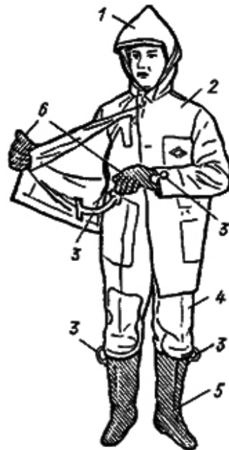
ნახ. 6.4. მაეკრანებელი კოსტუმი: 1 – დენგამტარი ქსოვილის კაპიშონი, რომელიც მიკერებულია ქურთუკზე; 2 – დენგამტარი ქსოვილის ქურთუკი; 3 – კოსტუმის ცალკეულ ელემენტებს შორის ელექტრული კავშირის განმახორციელებელი გამტარები; 4, 5, 6 – დენგამტარი ქსოვილის შარვალი, ჩექმები და ხელთათმანები
