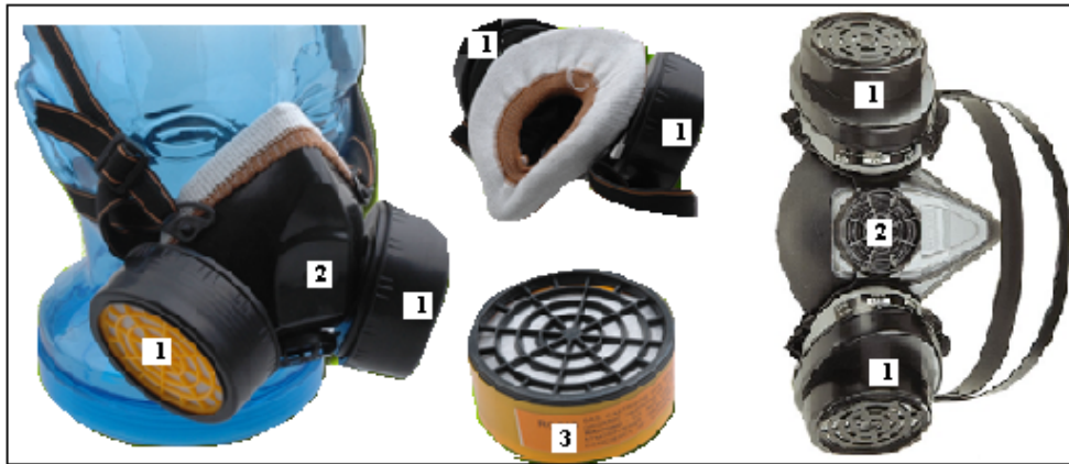
ნახ. 2.11. რესპირატორი: 1 – საფილტრი შესასუნთქი სარქველი ორივე მხარეზე; 2 – დამცავი ეკრანის მქონე ამოსასუნთქი სარქველი; 3 – რესპირატორის ფილტრი
